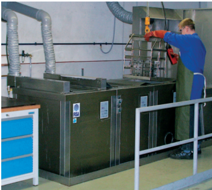
Zum Abschluß der Reinigung werden die Werkzeuge beschichtet.
