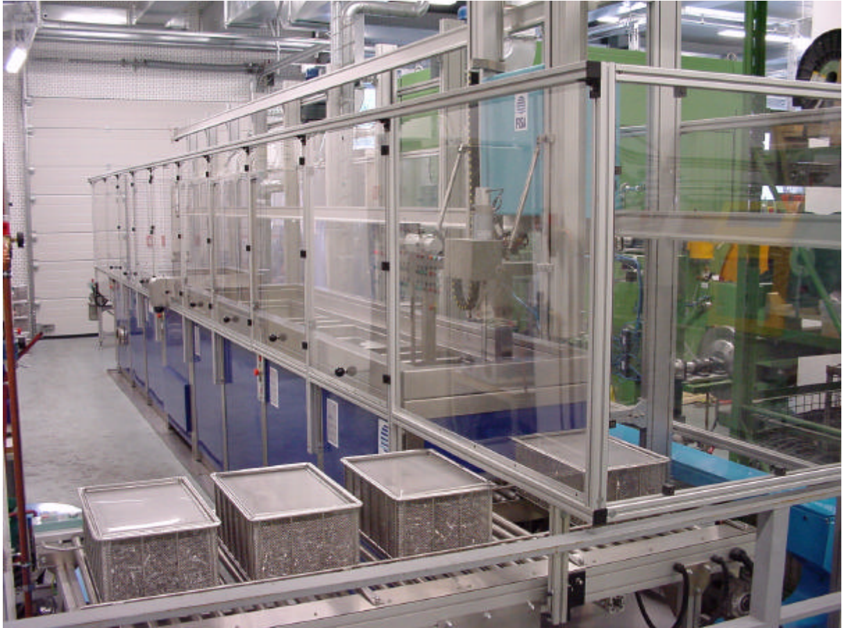
Kombinierte Ultraschall-Reinigungsanlage für Stanz- und Biegeteile sowie für Werkzeugeinsätze aus Spritzgußformen
