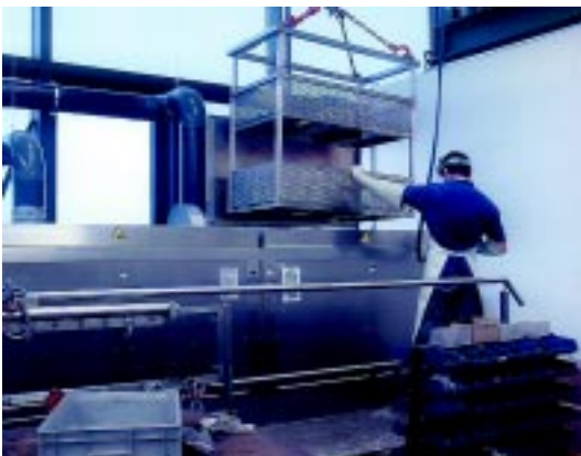
Bild 1 und 2: Die neue Anlage zur Reinigung der Spritzgusswerkzeuge ist im Mittel und Faktor 30 schneller als die händische Reinigung
