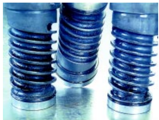
Bild 3 und 4: Es ist immer aufs Neue faszinierend, wie gründlich die Formen nach weniger als einer Stunde aus der Fisa-Anlage kommen. Monomere PET-Stäube außerhalb der Kontur, Gasrückstände und Formbeläge innerhalb der Kavität, Passungsrost, Rost- und Kalkbelag in den Kühlungen und Schmiermittelrückstände an Säulen und Gleitführungen werden rückstandslos entfernt
