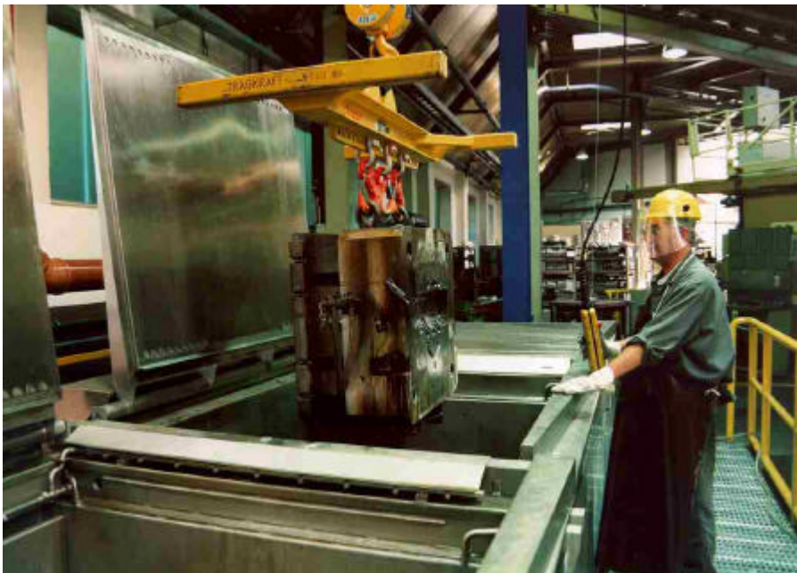
Bei der von Roll Druckguss AG in St. Gallen-Winkeln werden Druckgussstücke bis zu 10 kg gefertigt. Die Werkzeuge werden in Fisa-Ultraschall-Anlagen gereinigt.
