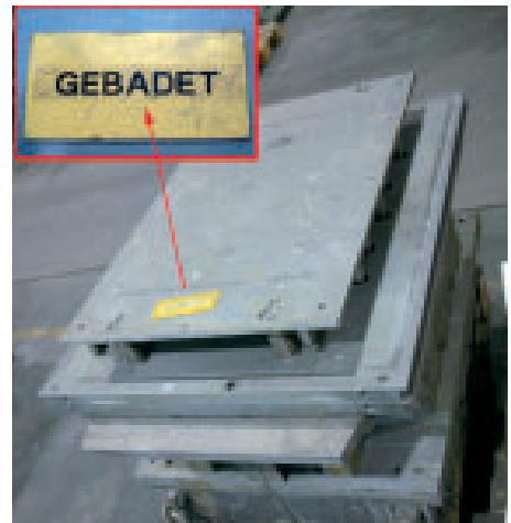
Güte-Siegel: Das Bild „Gebadet“ besagt, dass dieser Kernkasten wieder Produktionstauglich ist (Fotos: Vollrath)
