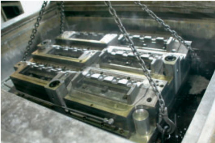
Jung-Brunnen: Nach nur einer halben Stunde sind die Schmutzkrusten völlig verschwunden, das Werkzeug ist wieder sauber und glänzend
