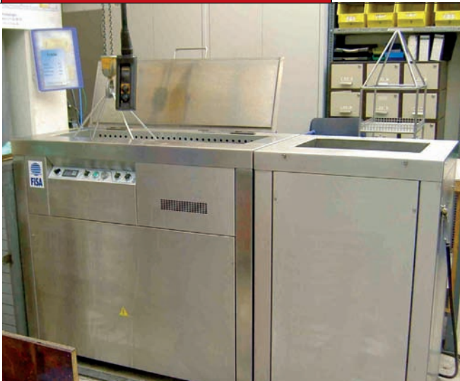
Die Anlagen zur Ultraschall-Reinigung der Werkzeuge werden auf die Anforderungen des Verarbeiters genau zugeschnitten.
