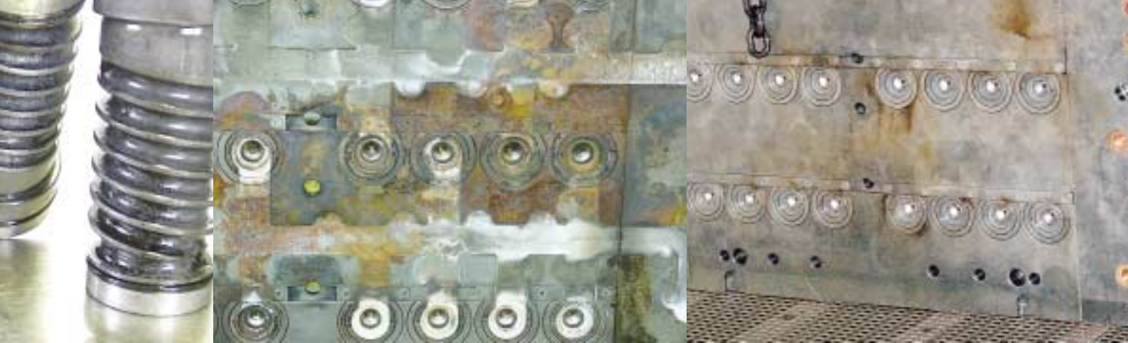
Monomere PET-Stäube außerhalb der Kontur, Gasrückstände und Formbeläge innerhalb der Kavität. Passungsrost, Rost- und Kalkbelag in den Kühlkanälen und Schmiermittelrückstände an Säulen und Gleitführungen werden rückstandslos entfernt.
